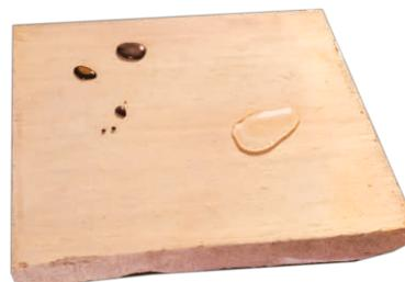
**L'IMPORTANZA DEL PRETRATTAMENTO:** Pretrattare il cotto in linea mediante un processo a immersione con soluzione idrorepellente, proteggendolo da tutti i lati, determina una serie di notevoli vantaggi: in fase di stoccaggio del materiale
